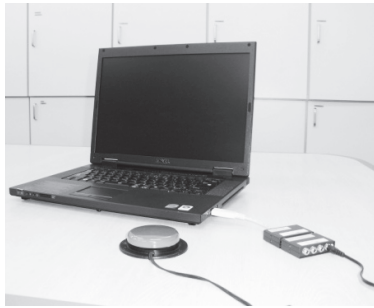
図5 パソコンとスイッチの接続方法
