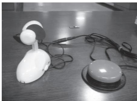
図 10 小型扇風機とスイッチをつなげる
